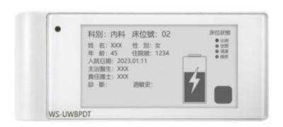
UWB定位顯示標籤是一種基於UWB (Ultra Wideband) 技術的定位設備,可用於定位和追蹤物品、人員等目標。
